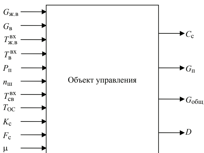
Рис. 2. Входные и выходные параметры объекта управления
