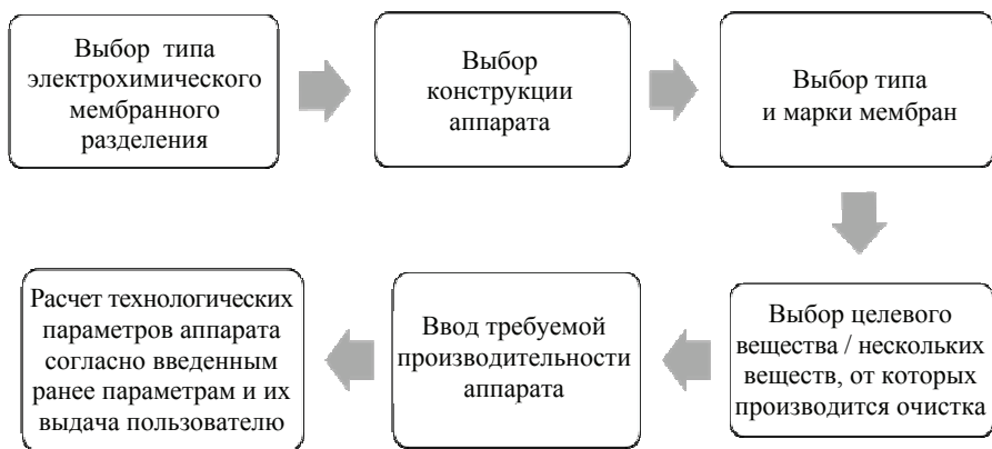
Рис. 1. Общая схема функционирования программного комплекса
